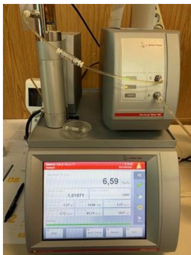
Slika 24 Prikaz dobivenih rezultata na uređaju Beer Analyzer tvrtke Anton Paar (izvor: privatna arhiva)
