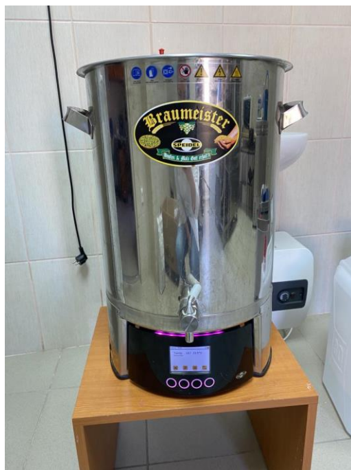
Slika 2 Speidel Braumeister električna posuda za kuhanje piva (izvor: privatna arhiva)
