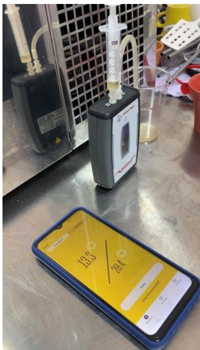
Slika 16 Ispitivanje prividne količine šećera u sladovini nakon kuhanja (izvor: privatna arhiva)
