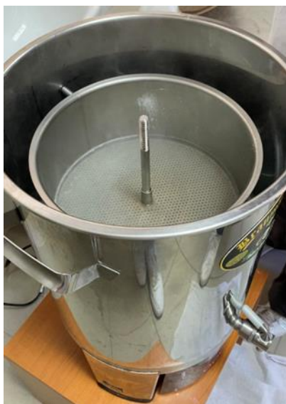
Slika 7 Prikaz postavljanja sita na dno uređaja Speidel Braumeister (izvor: privatna arhiva)
