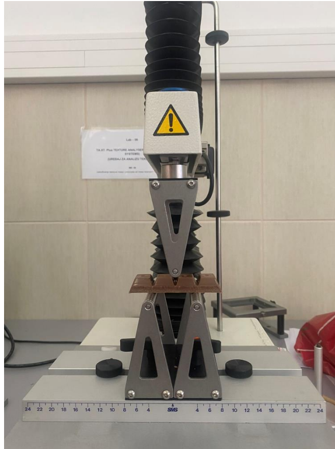
Slika 9 Uređaj za određivanje čvrstoće metodom lomljenja TA.XT Texture Analyser
