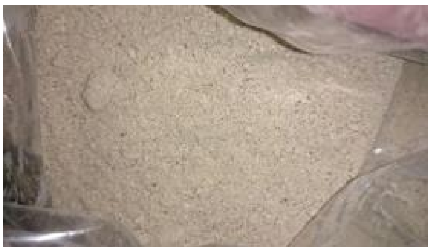
Slika 7 Pogača od jezgre lješnjaka nakon superkritične ekstrakcije s ugljikovim dioksidom (Rot, 2015)
