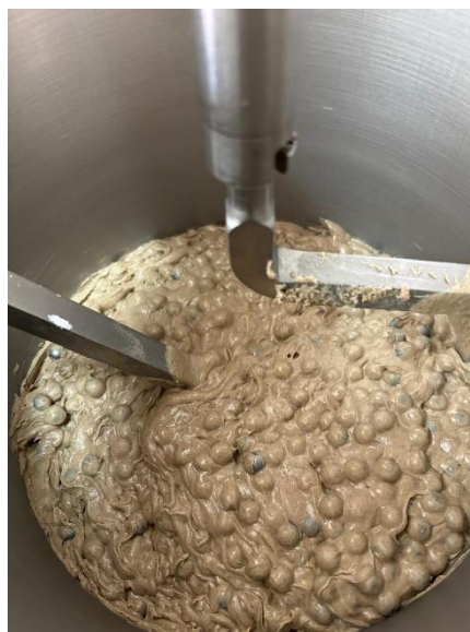
Slika 33 Unutrašnjost kugličnog mlina tijekom izrade mliječnog krem-proizvoda
