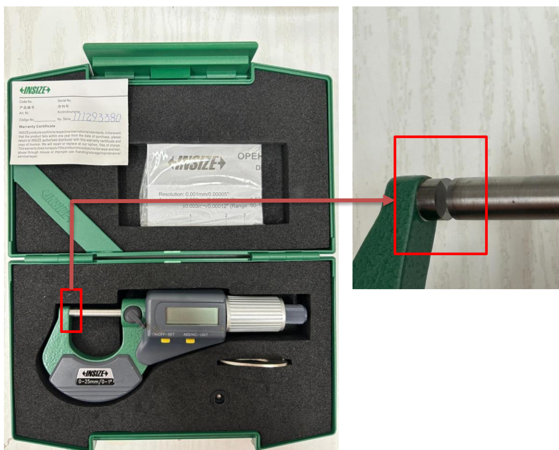
Slika 37 Mikrometar (lijevo) te zazor (desno)
