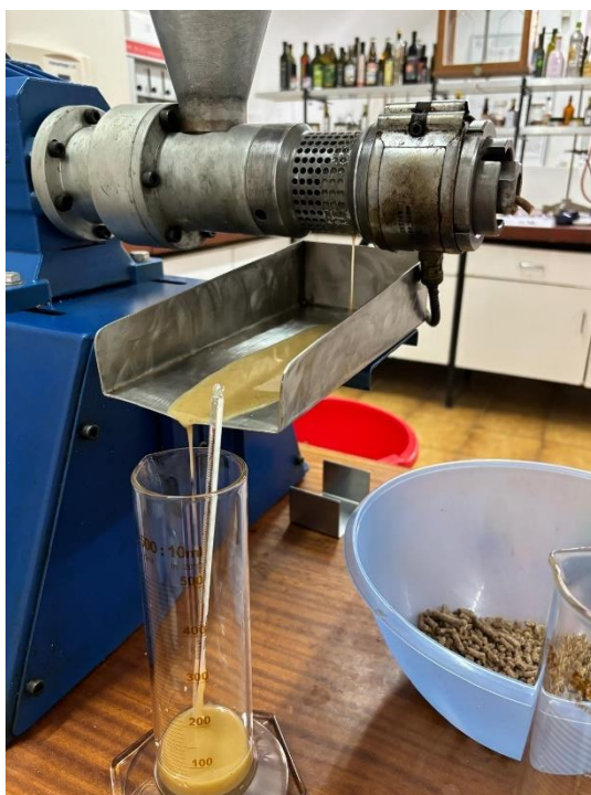
Slika 2 Pužna preša pri proizvodnji hladno prešanog lješnjakovog ulja
