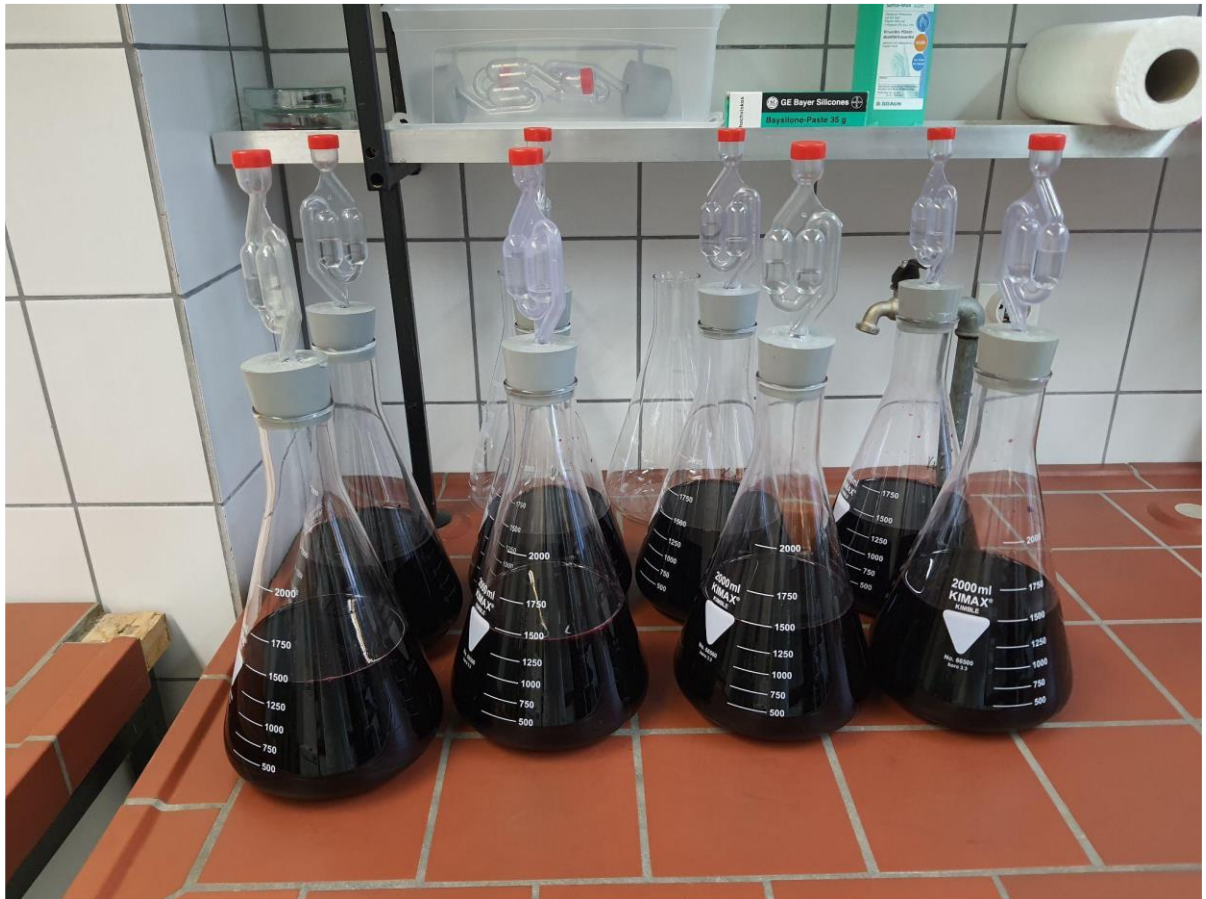
Slika 5 Pripremljeni uzorci u Erlenmeyerovim tikvicama u vrenjačama (Izvor: Autor)
