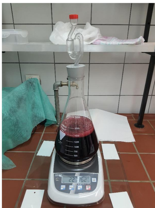
Slika 9 Mjerenje mase uzoraka tijekom provedbe mikrofermentacije (Izvor: Autor)
