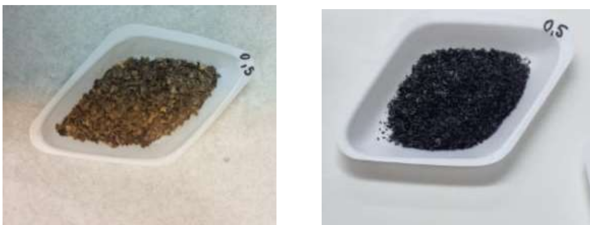
Slika 3 Heljdine ljuskice prije torefakcije (a) i biougljen dobiven torefakcijom i funkcionalizacijom s H 2 SO 4 (b)
