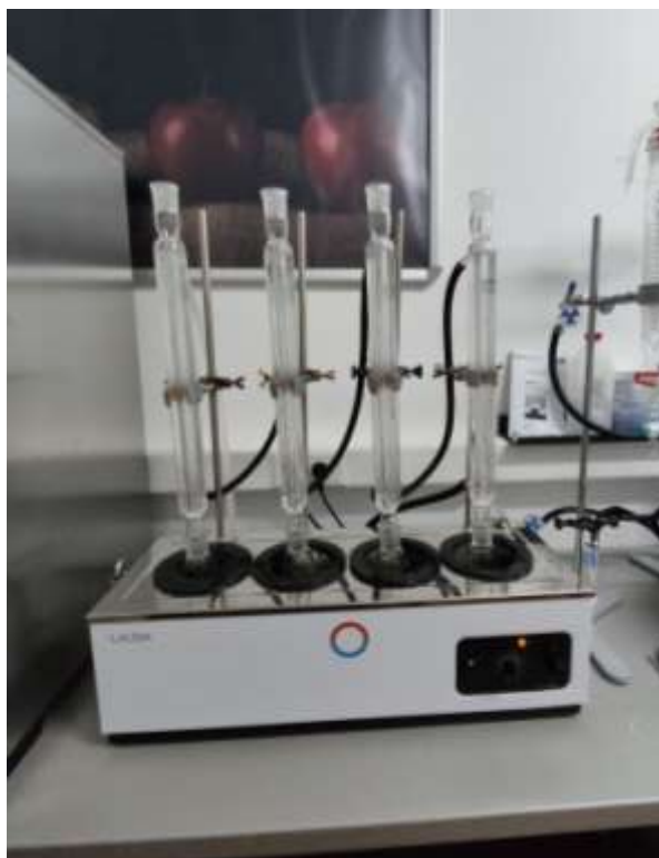
Slika 25 Aparatura za uklanjanje ugljične kiseline
