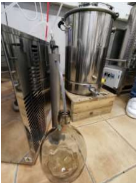
Slika 23 AC filter spojen direktno na destilacijski kotao
