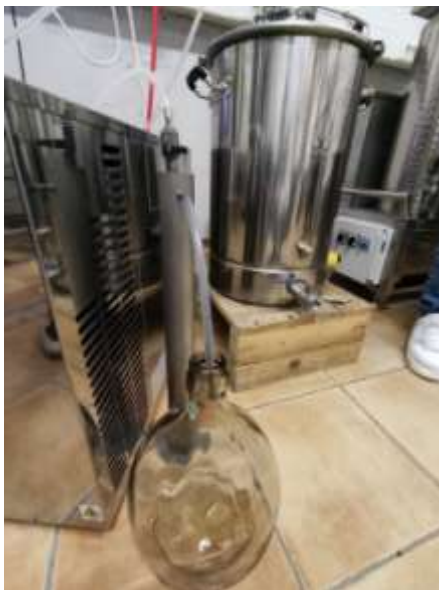
Slika 23 AC filter spojen direktno na destilacijski kotao
