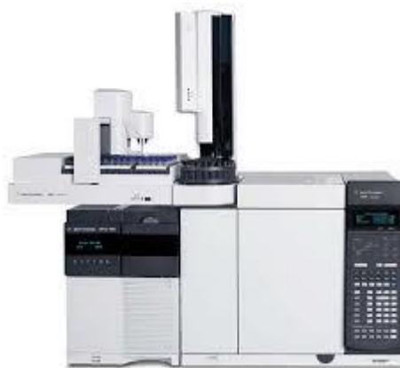
Slika 13 Plinski kromatograf Agilent 7890 B s masenim detektorom Agilent 5977 (Web 13)
