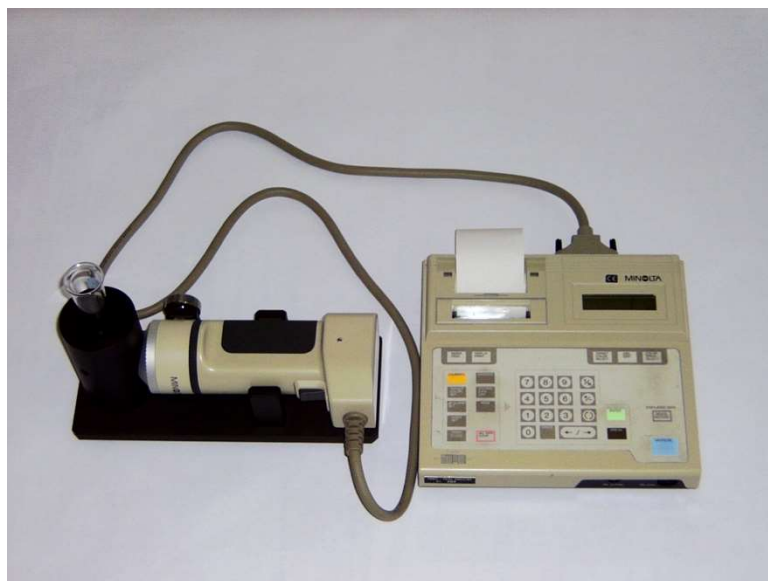
Slika 7 Kromametar Minolta CR-300 s nastavkom CR-A70
