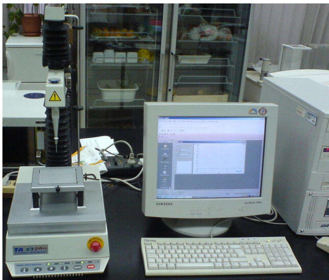
Slika 9 Teksturometar TA.XT plus (Stable Micro Systems, Velika Britanija)
