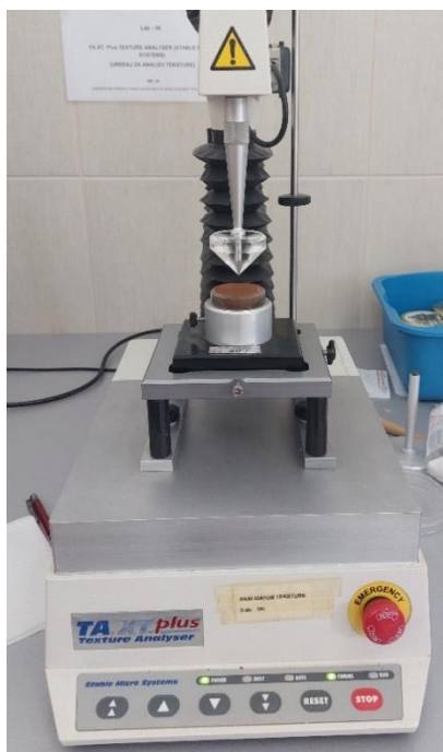
Slika 19 Analizator teksture TA.XT2 Plus, Stable Micro System
