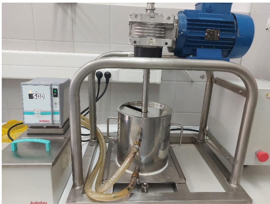
Slika 14 Laboratorijski kuglični mlin
