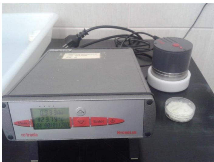
Slika 18 HygroLab 3 (uređaj za određivanje aktiviteta vode)
