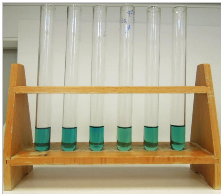
Slika 9 Reakcijska smjesa uzorka i otopine ABTS
