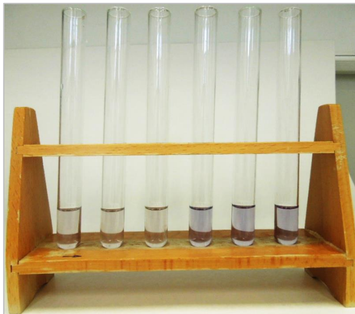
Slika 11 Reakcijska smjesa uzorka i FRAP otopine
