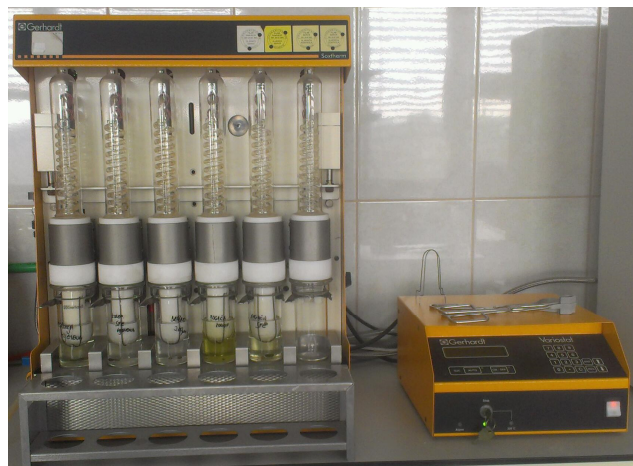
Slika 21. Soxhterm ekstrakcijski uređaj za određivanje masti i ulja
