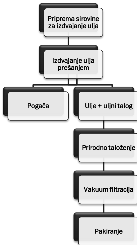
Slika 6 Shema proizvodnje ulja chie
