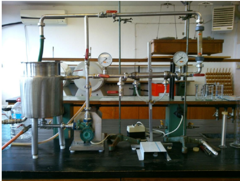
Slika 16 Fotografija laboratorijske aparature za mikrofiltraciju i ultrafiltraciju
