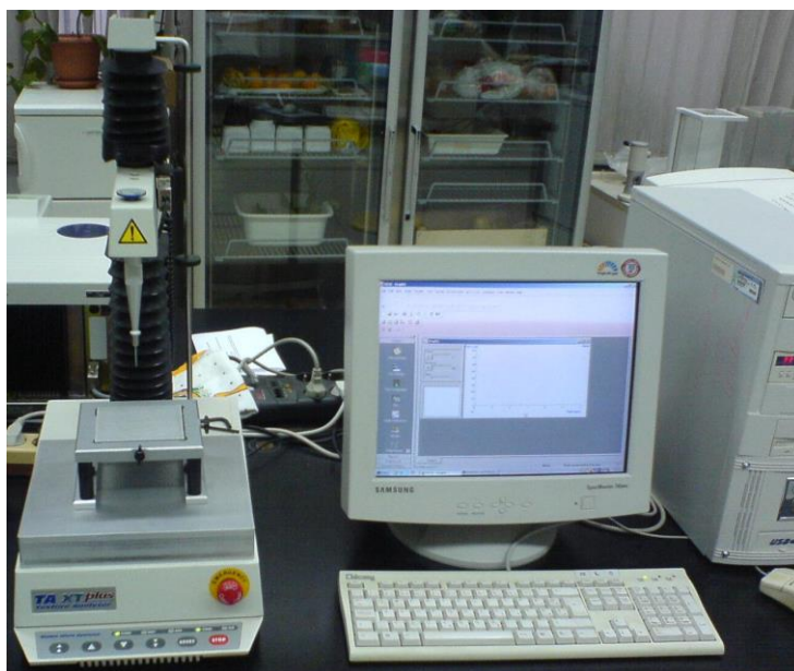
Slika 6 Teksturometar TA.XT (Stable Micro System, Velika Britanija)
