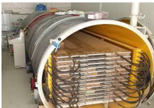
Slika 8. Vakuum sušara ( www.bojovicsirogojno.com )
