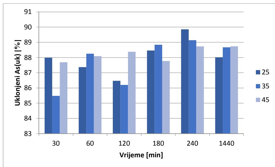
**Slika 19** Masa adsorbiranog ukupnog arsena na adsorbens pripravljen od ljuške lješnjaka ovisno o vremenu i temperaturi adsorpcije
