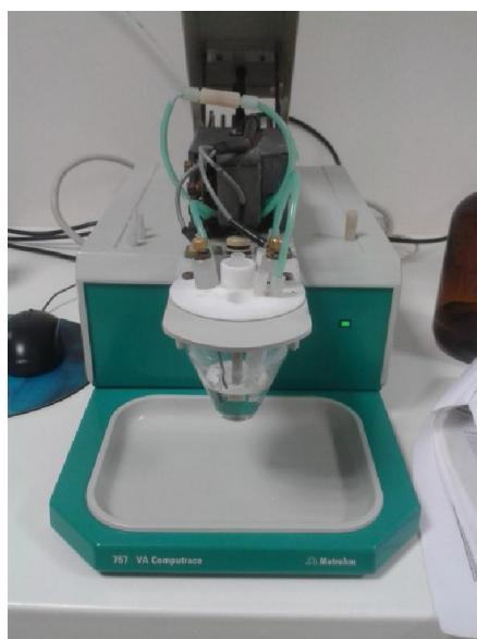
**Slika 16** Voltametar „Computrace 757 VA“ Metrohm
