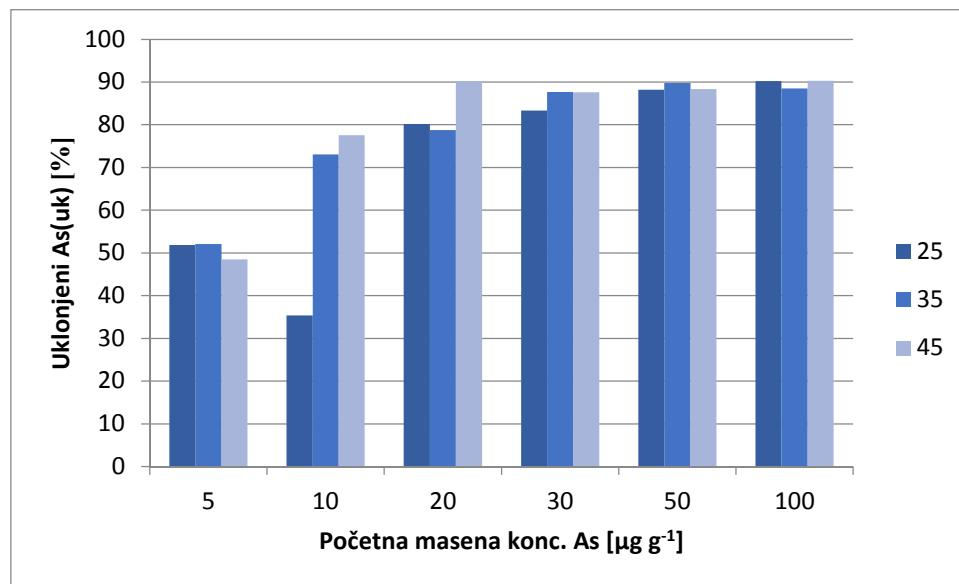
**Slika 17** Masa adsorbiranog ukupnog arsena na aktivni ugljen pripravljen od ljske lješnjaka i zasićen trvovalentnim željezom ovisno o početnoj koncentraciji i temperaturi adsorpcije
