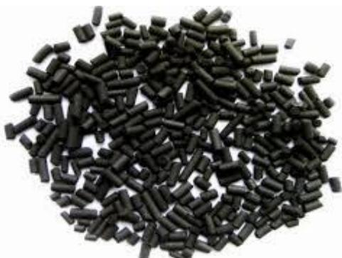
**Slika 8b** Peletirani aktivni ugljen
