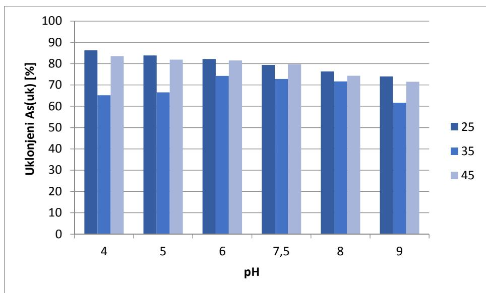
**Slika 21** Masa adsorbiranog ukupnog arsena na adsorbens pripravljen od ljske lješnjaka ovisno o pH-vrijednosti i temperaturi adsorpcije
