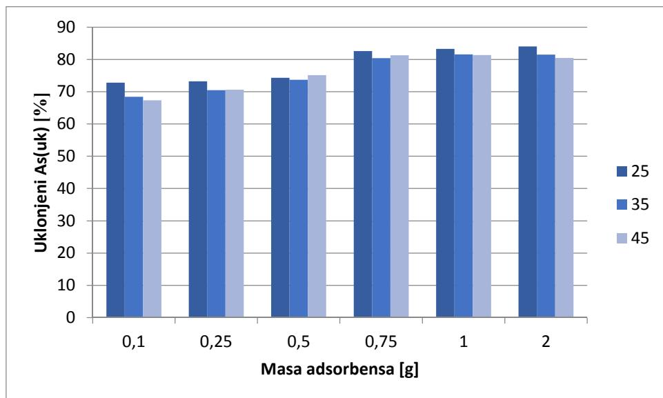
**Slika 23** Masa adsorbiranog ukupnog arsena na adsorbens pripravljen od ljuške lješnjaka ovisno o masi adsorbensa i temperaturi adsorpcije
