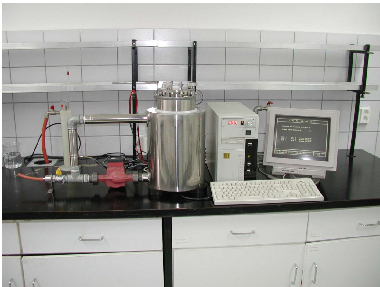
Prilog 1. Fotografija uređaja za određivanje koeficijenta toplinske vodljivosti metodom paralelnih ploča (TC1)
