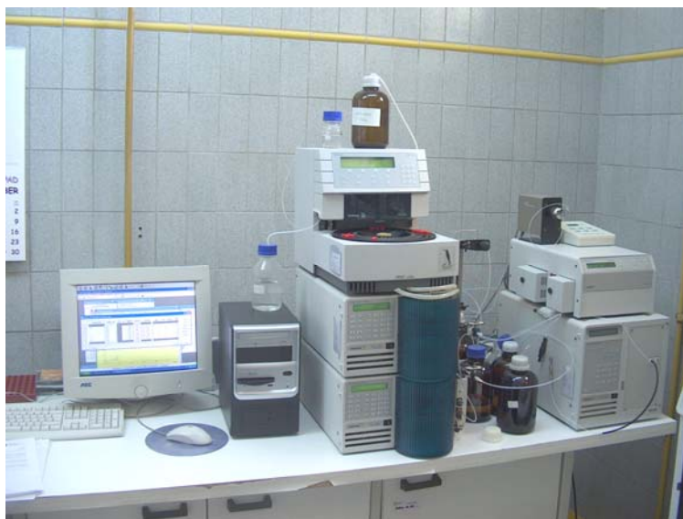
Slika10. Prikaz sustava za provedbu tekućinske kromatografije visokog učinka
