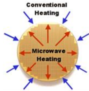
Slika 10. Slikoviti prikaz razlike konvencionalnih metoda zagrijavanja u odnosu na mikrovalno zagrijavanje.
