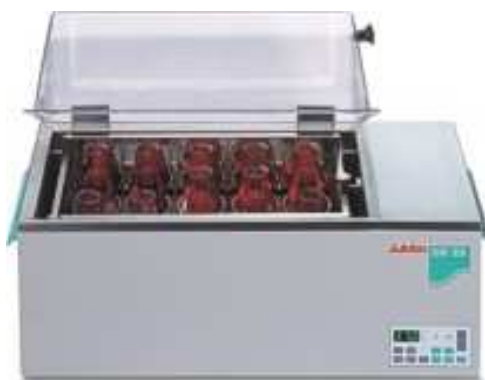
Slika 3.1. Vodena kupelj s tresilicom (Julabo SW-23)
