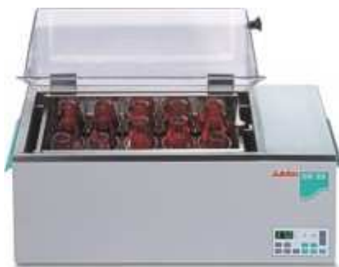
Slika 3.1. Vodena kupelj s tresilicom (Julabo SW-23)
