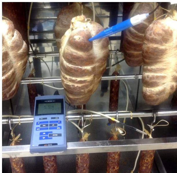
Slika 3 Određivanje pH vrijednosti kulena
