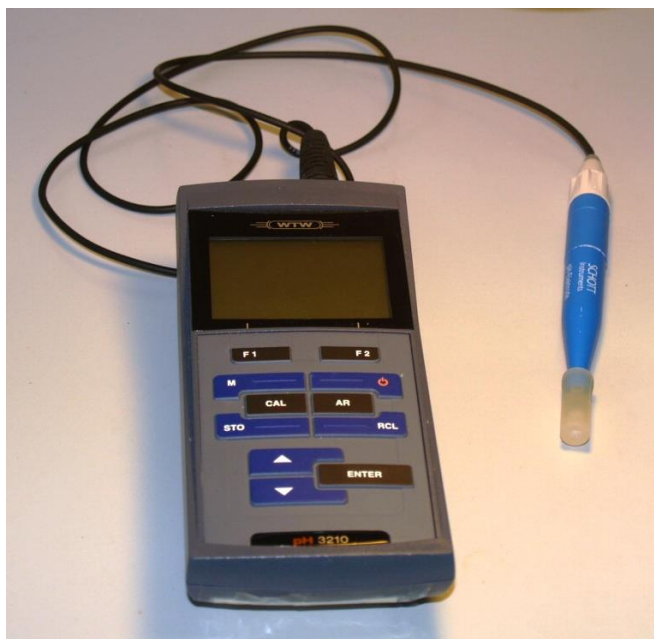
Slika 14. Prijenosni pH metar pH 3210/3310 tvrtke WTW
