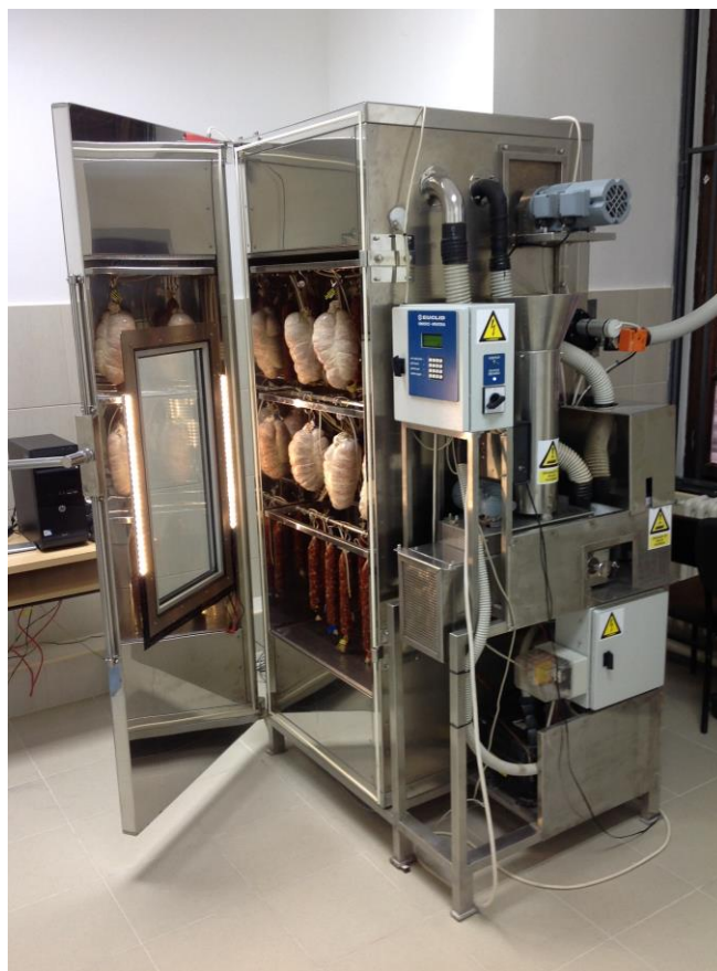
Slika 12 Automatizirana komora za zrenje kulena
