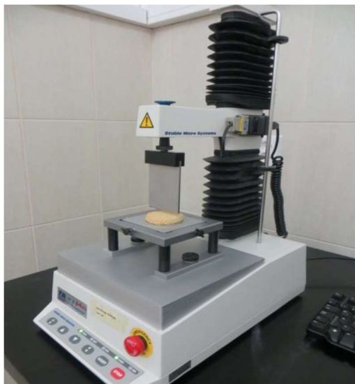
Slika 5. Analizator teksture TA.XT s opremom za savijanje/lomljenje uzorka
