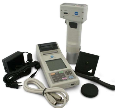
Slika 8 Kolorimetar (Konica Minolta Chroma Meter CR-400).
