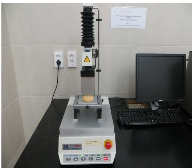
Slika 4 Analizator teksture TA.XT s opremom za lomljenje uzorka
