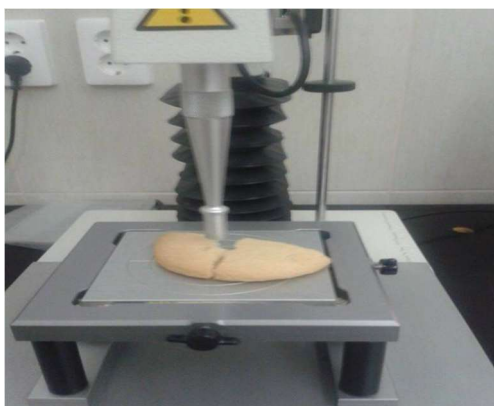
Slika 7 Analizator teksture TA.XT s opremom za prodiranje u uzorak
