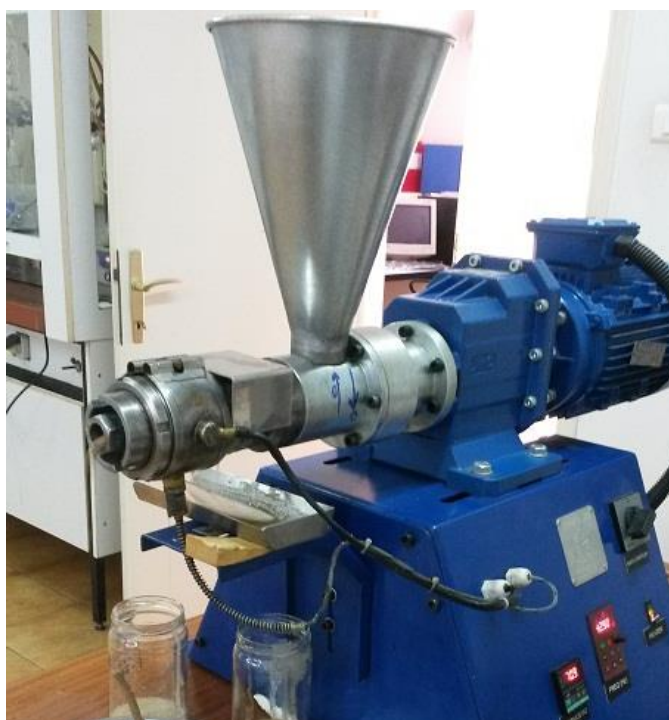
Slika 8 Pužna preša pomoću koje smo proizveli hladno prešano ulje iz koštica marelice
