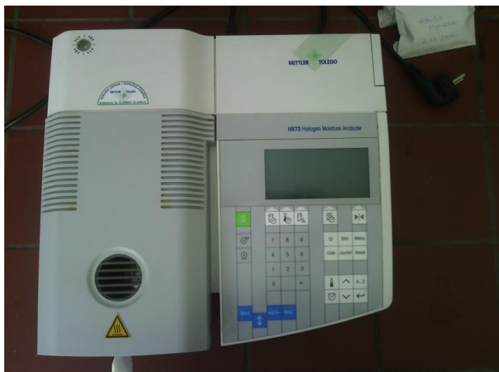
Slika 5. Halogeni vlagomjer (Mettler Toledo HR73).
