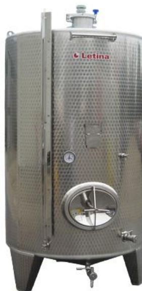
Slika 22 Inoks tank za čuvanje vina (Web 22)
