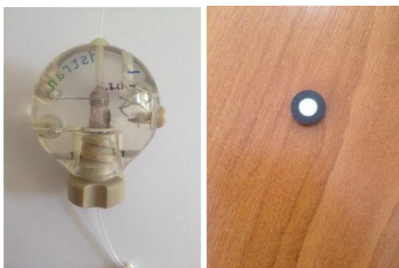
Slika 20 FTSCP ćelija i mikroporozna elektroda.
