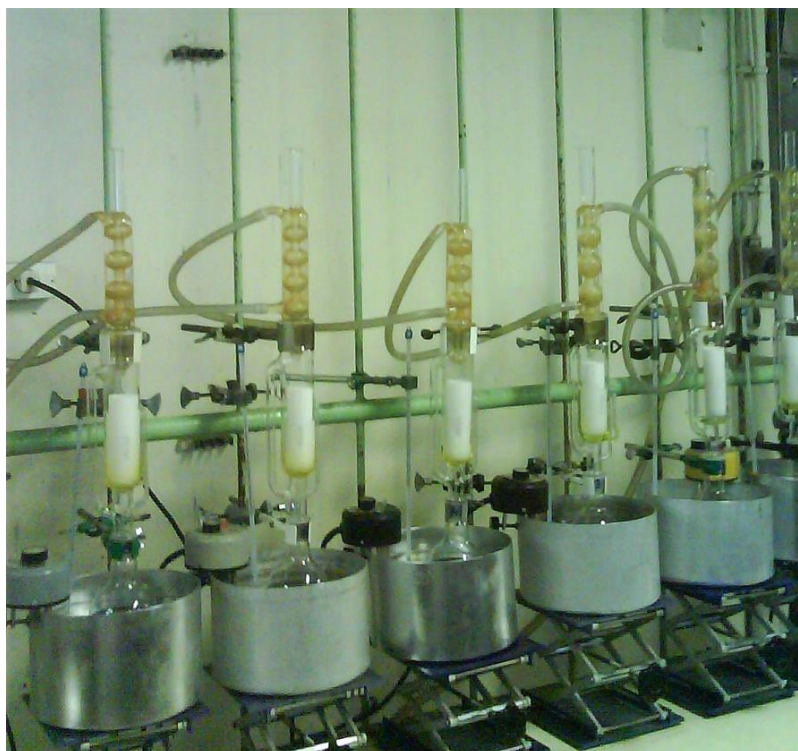
Slika 19. Soxhlet-ova aparatura za ekstrakciju (Izvor autor)
