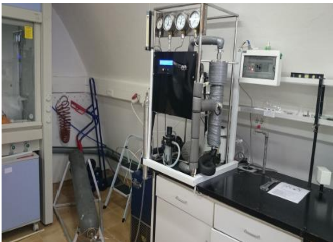
Slika 20. Uređaj za ekstrakciju superkričnim CO 2 (Aladić, 2015)
