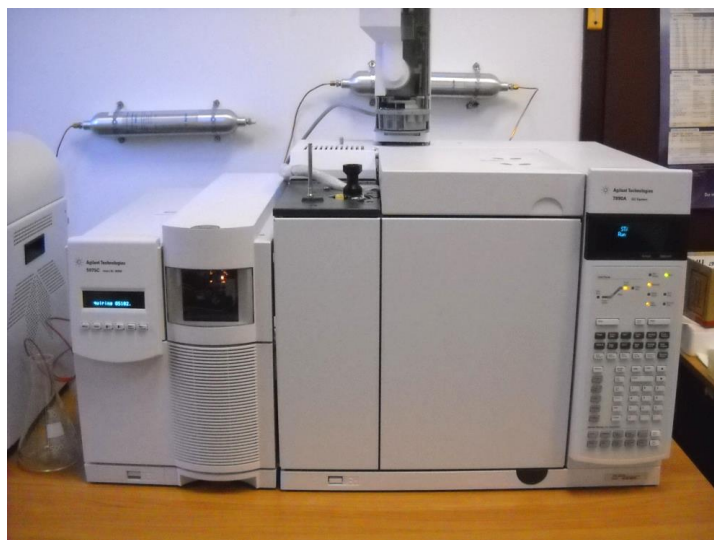
Slika 22. Vezani sustav plinska kromatografija-spektrometrija masa (GC-MS) (Izvor autor)
