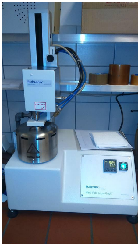
Slika 9 Brabenderov Mikro-visko amilograf
