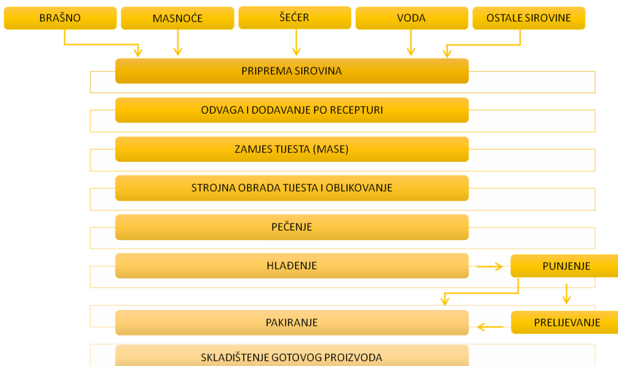
Slika 10 Shema procesa proizvodnje čajnog peciva
