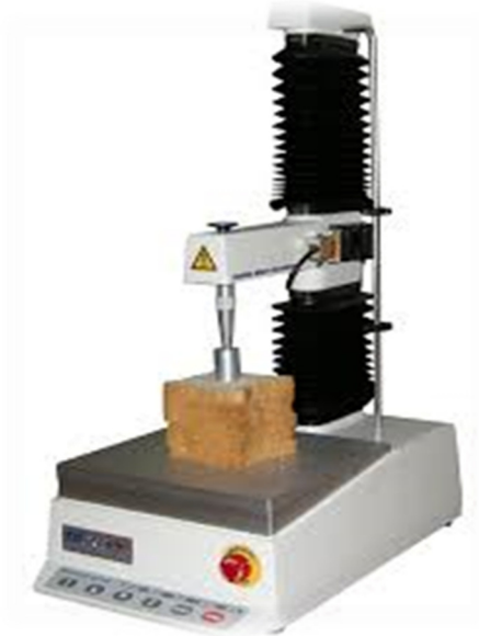
Slika 13 Uređaj za određivanje teksturalnog profila uzorka TA.XT Plus TextureAnalyzer
