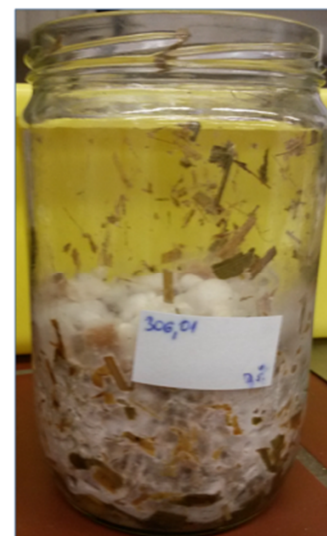
Slika 5. Prikaz porasta micelija T. versicolor na kukuruznoj silaži nakon 6 dana fermentacije u uvjetima na čvrstim nosačima
