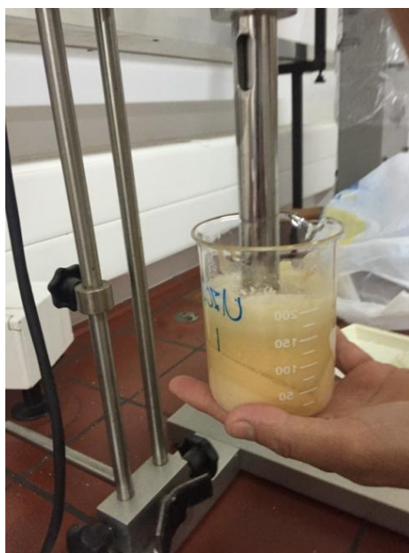
Slika 5. Prikaz procesa homogenizacije sa laboratorijskim homogenizatorom
