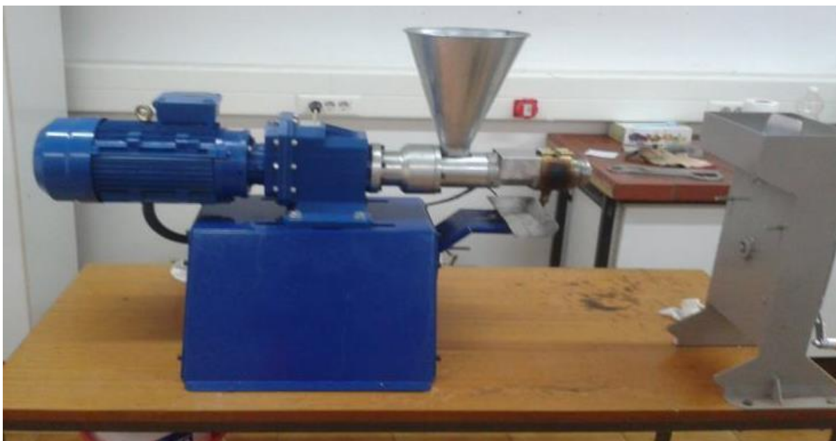
Slika 7. Pužna preša za proizvodnju ulja iz koštice marelice
