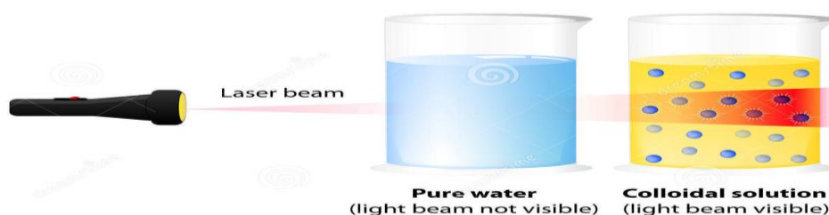
Slika 5. Prikaz Tyndallova efekta (put svjetlosti je vidljiv u koloidnoj otopini).
