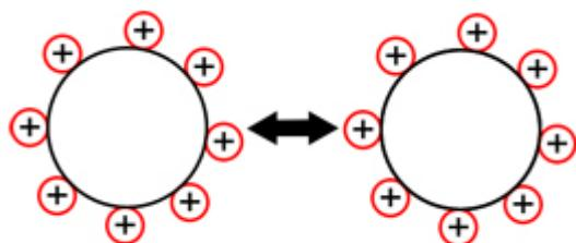
Slika 4 Elektrostatička stabilizacija
