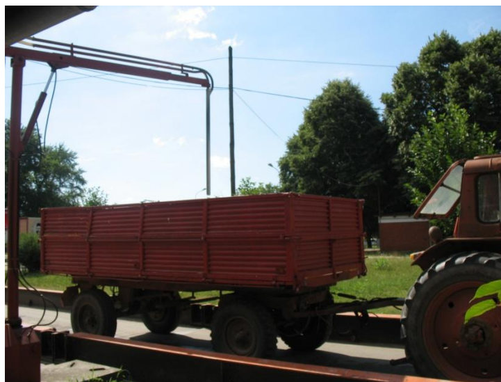
Slika 15. Uzimanje uzorka ječma automatskom sondom (snimila M. Barić)
