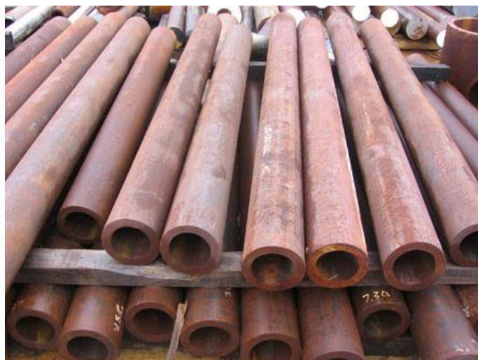
Slika 3. Cijevi zahvaćene korozijom
