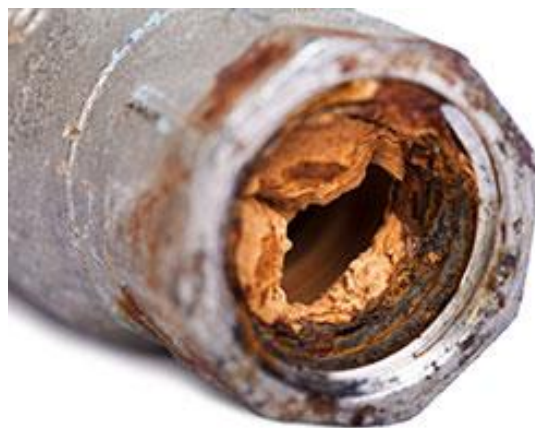
Slika 2. Pojava kamenca u cijevima uslijed prijenosa topline
