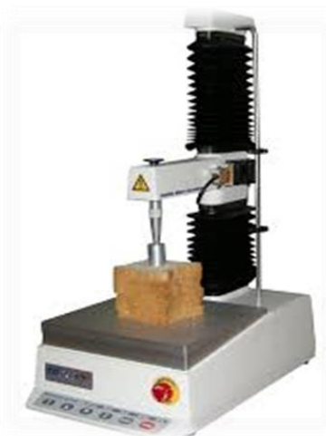
Slika 13. Uređaj TA.XT Plus TextureAnalyzer
