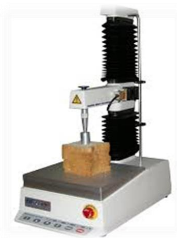
Slika 13. Uređaj TA.XT Plus TextureAnalyzer
