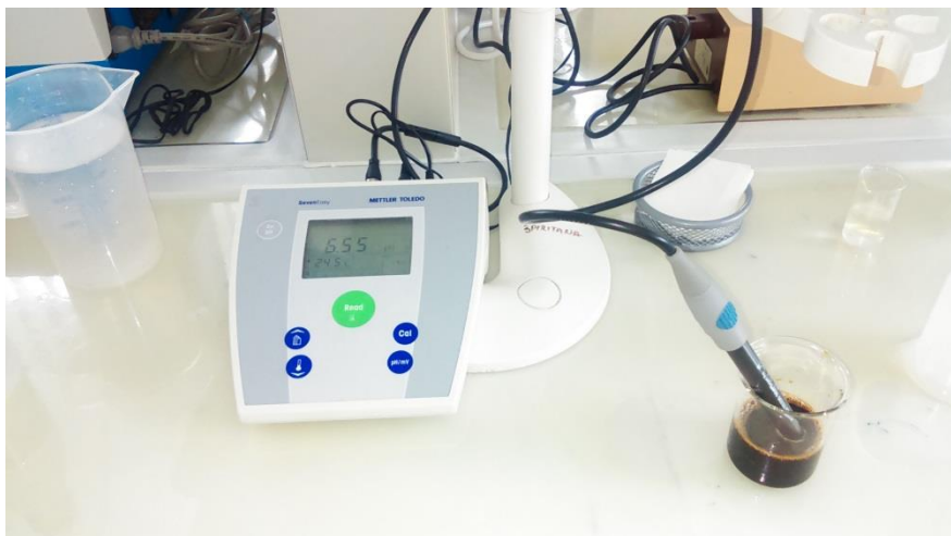
Slika 2 Prikaz mjerenje pH vrijednosti
