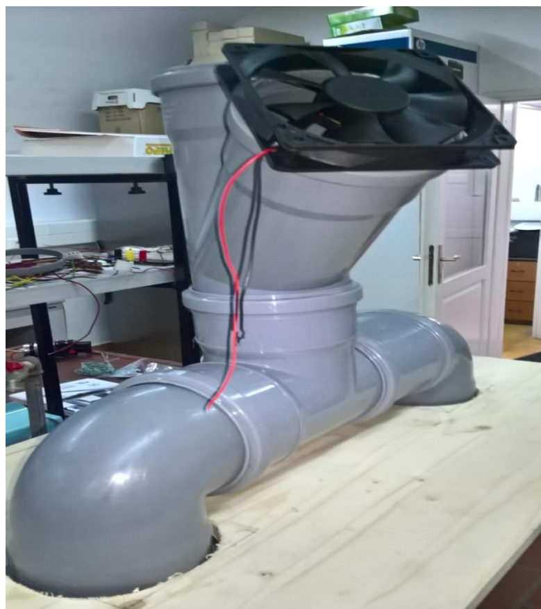
Slika 12 Ventilator pričvršćen na rub cijevi
