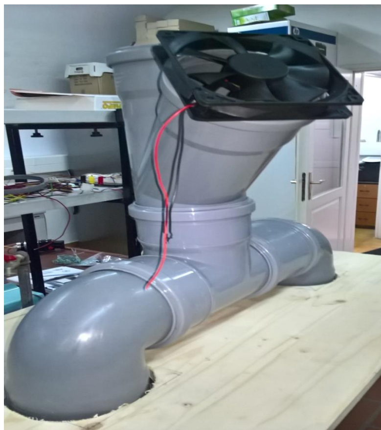
Slika 12 Ventilator pričvršćen na rub cijevi
