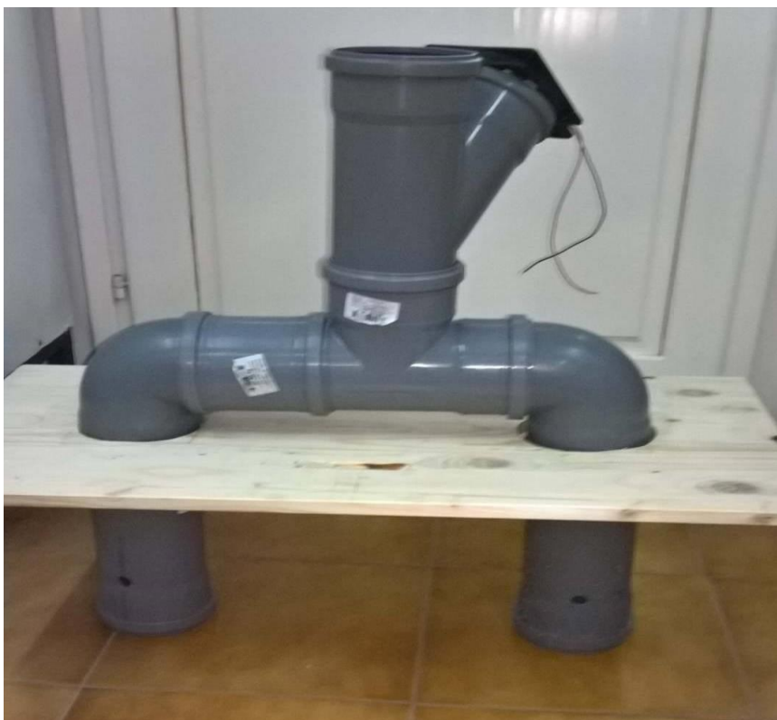
Slika 11 Prikaz spojenih PP cijevi provučenih kroz glavnu ploču
