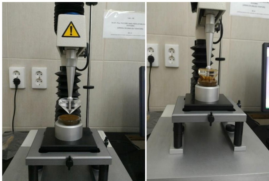
Slika 22 Prikaz prodiranja nastavka za teksturu konusnog oblika
