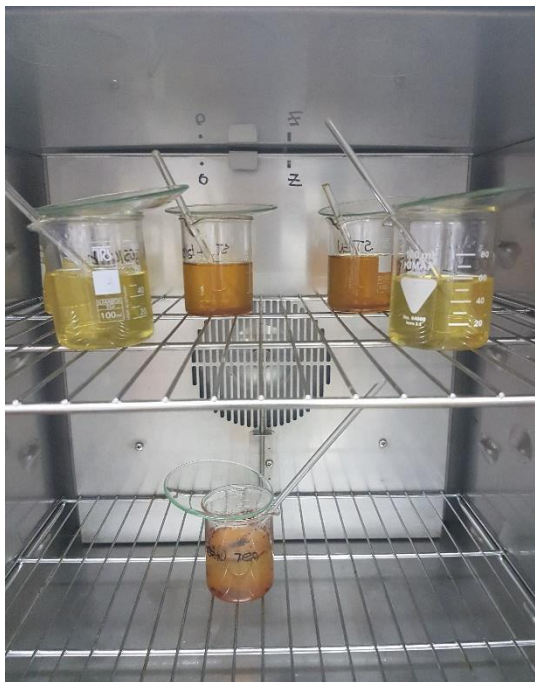
Slika 20 Pripremljeni uzorci prekriveni satnim stakalcem u sušioniku
