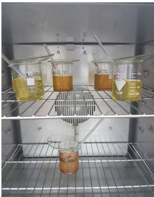
Slika 20 Pripremljeni uzorci prekriveni satnim stakalcem u sušioniku
