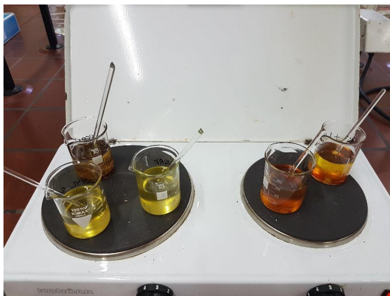
Slika 19 Zagrijavanje uzoraka na 70 °C kroz 30 minuta
