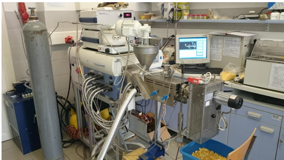
Slika 8 Laboratorijski jednupužni ekstruder Brabender 19/20 DN na PTF-u s instaliranom opremom za dodavanje superkritičnog CO 2
