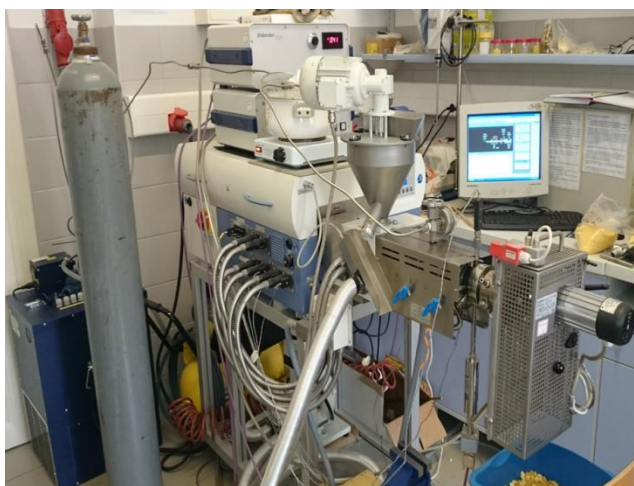
Slika 8 Jednopusni ekstruder na PTF-u s mogućnošću dodatka superkričnog CO 2 (Brabender 19/20 DN)
