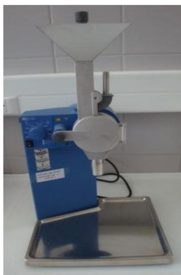
Slika 9 Laboratorijski mlin IKA MF10
