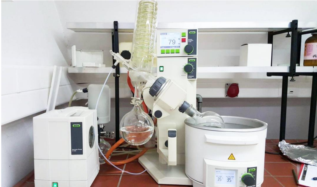
Slika 7 Rotacijski vakuumski uparivač (Izvor: autor)
