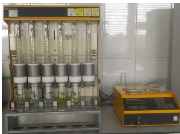
Slika 6 Soxhtherm ekstrakcijski uređaj za određivanje masti i ulja (Aladić, 2015)
