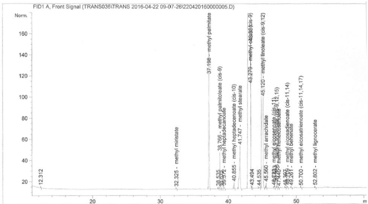
Slika 11 Kromatogram masnih kiselina u ulju sjemenki marelice dobivenog hladnim prešanjem
