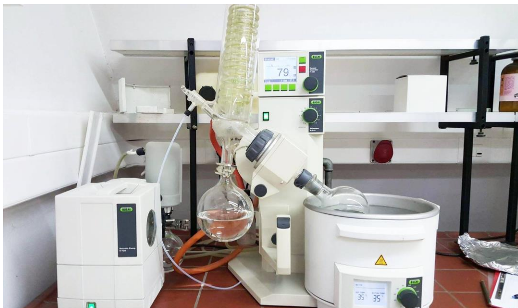
Slika 7 Rotacijski vakuumski uparivač (Izvor: autor)
