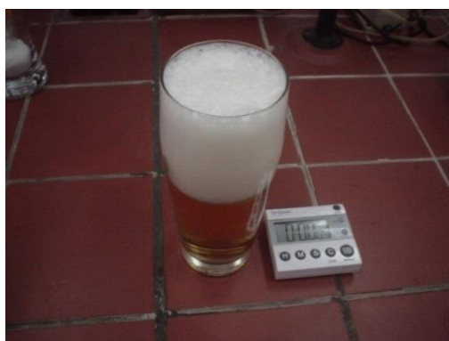
Slika 41 Mjerenje trajnosti pjene prema Ullmann i Pfenningeru
