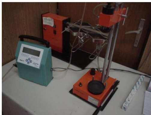
Slika 45 Okretač boca BT-002, LG-automatic aps., Oksimetar Digox 5
