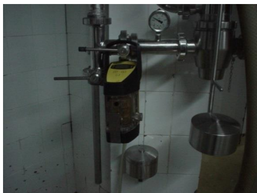
Slika 40 CO 2 /O 2 Norit Haffmans c-DGM-om
