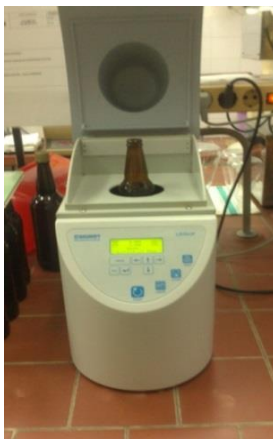
Slika 44 Mjerenje bistroće/mutnoće poslije toplo-hladnog tretmana
