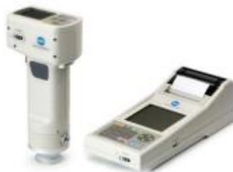
Slika 4 Kromametar Konica Minolta CR-400 (Jozinović, 2015)
