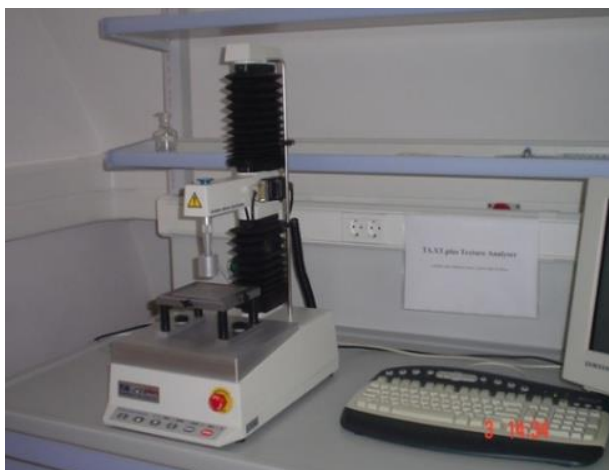
Slika 5 TA.XT2 Plus Texture Analyser (Tanasković, 2014.)
