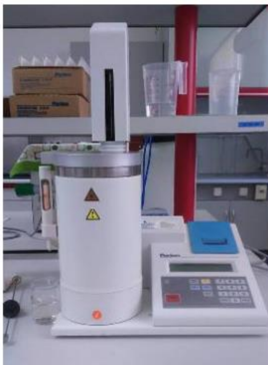
Slika 9 Uređaj za određivanje broja padanja
