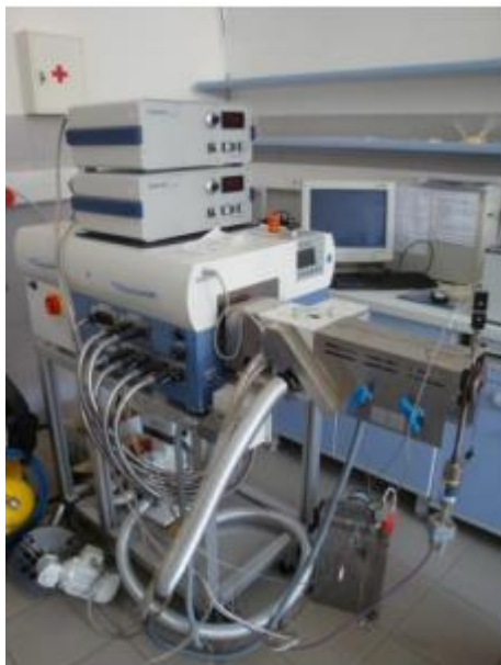
Slika 7 Laboratorijski jednopužni ekstruder Brabender 19/20 DN
