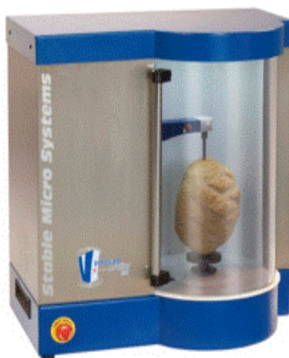
Slika 7 Uređaj za mjerenje volumena čajnog peciva VolScan Profiler (web 5)
